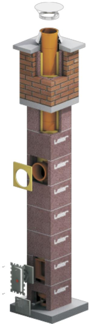
Изолированный дымоход Leier ECO Plus - идеален для использования в жилых домах (особняках). Служит для подключения целого ряда систем отопительного оборудования с открытой камерой сгорания для различных видов топлива - газовых котлов, каминных топков, котлов на твердом и жидком топливе. Через дымоходную трубу, которая содержит вспомогательную шахту, можно поставлять воздух, необходимый для горения.
