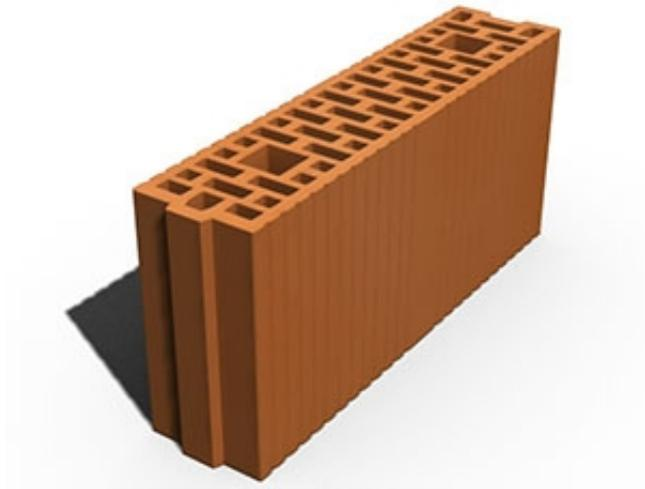
Крупноформатные керамические блоки **Leiertherm 11,5** предназначены для возведения внутренних несущих межкомнатных стен. Для кладки 1 м<sup>2</sup> стены нужно всего 8 блоков **Leiertherm 11,5**. Большой размер и пазогребневые соединения блоков позволяют сократить расход раствора для кладки и снизить трудозатраты примерно на 15% при достижении повышенной ровности стены.
