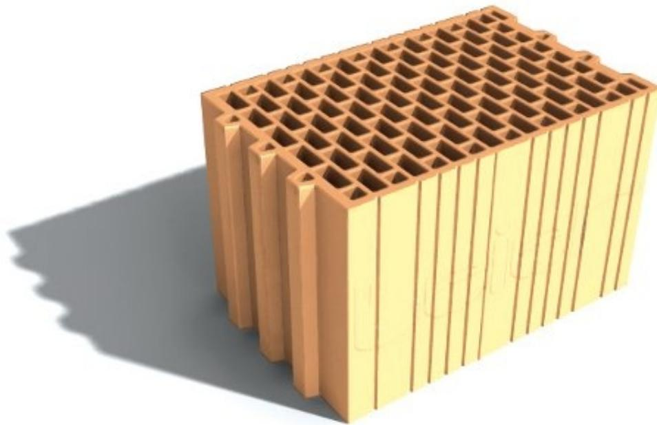
Крупноформатные керамические блоки **Leiertherm 25** предназначены для возведения наружных и внутренних несущих стен зданий. Для кладки 1 м<sup>2</sup> стены нужно всего 10,7 блоков **Leiertherm 25**. Большой размер и пазогребневые соединения блоков позволяют сократить расход раствора для кладки примерно в 4,4 раза (75л: 17л) и снизить трудозатраты примерно на 20% при достижении повышенной ровности стены.
