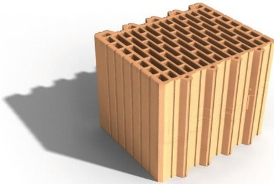
Крупноформатные керамические блоки **Leiertherm 30** предназначены для внешних и внутренних несущих стен зданий в один ряд толщиной 300 мм. Для кладки 1 м<sup>2</sup> стены нужно всего 16 блоков **Leiertherm 30**. Большой размер и пазогребневые соединения блоков позволяют сократить расход раствора для кладки и снизить трудозатраты примерно на 20% при достижении повышенной ровности стены.
