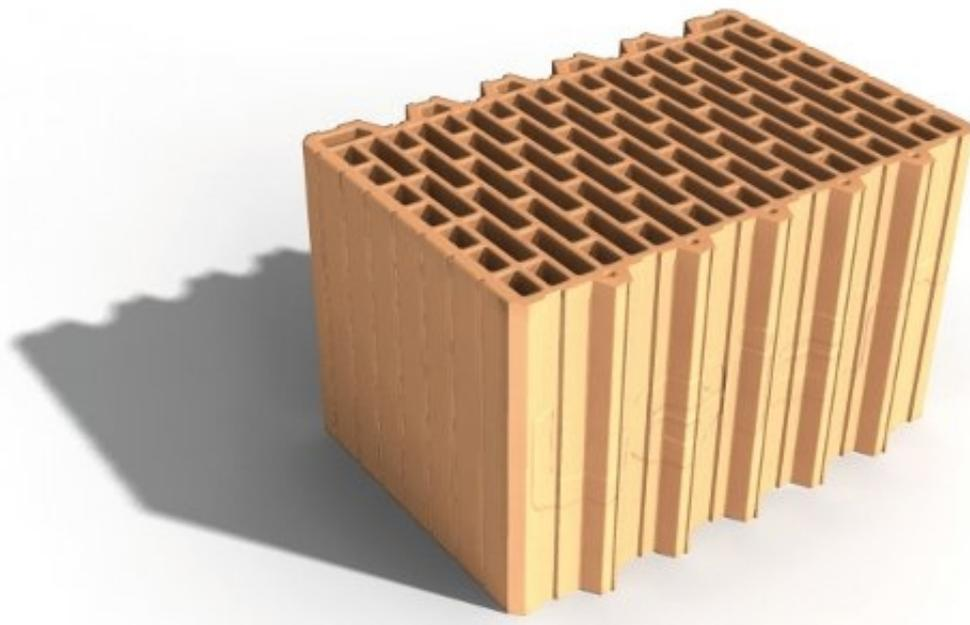
Крупноформатные керамические блоки **Leiertherm 38** предназначены для внешних и внутренних несущих стен зданий в один ряд толщиной 380 мм. Для кладки 1 м<sup>2</sup> стены нужно всего 16 блоков **Leiertherm 38**. Большой размер и пазогребневые соединения блоков позволяют сократить расход раствора для кладки примерно в 4,42 раза (115л: 26л) и снизить трудозатраты примерно на 20% при достижении повышенной ровности стены.
